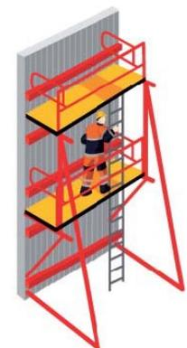
Рис. 2. Рабочие платформы опалубки
